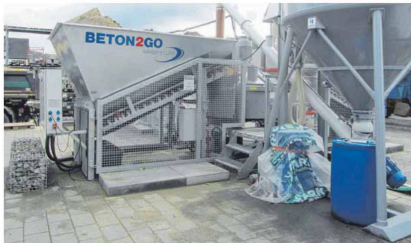
An dieser Betontankstelle erhält man fertig gemischten Beton. FOTO: FRANZ DREYER
